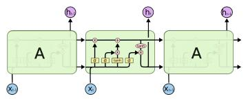
Three gates: input  $(i_t)$ , forget  $(f_t)$ , out  $(o_t)$
